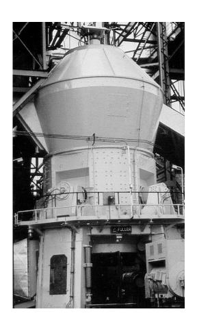
采用煤做燃料的回转窑,需要配备 磨煤机。其尺寸比立磨略小。 磨煤机中的磨辊轴承,齿轮箱轴承
